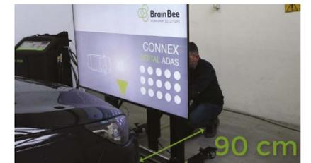
4. INTRODUCIR LOS VALORES REQUERIDOS, USANDO LOS DOS MEDIDORES LÁSER DE DISTANCIA. ESTOS PARÁMETROS SON NECESARIOS PARA EJECUTAR LA FUNCIÓN .
