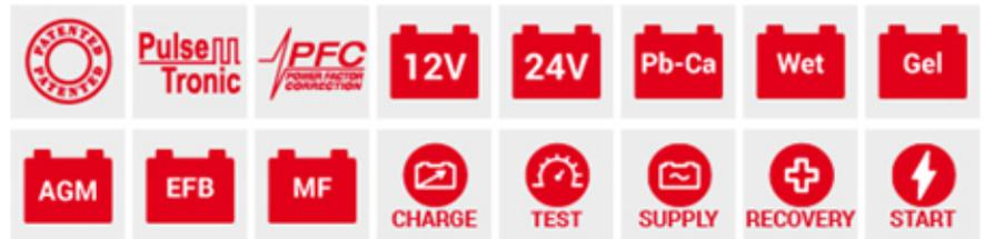
Cargador de baterías inverter multifunción (BATTERY MANAGER) para el mantenimiento completo de baterías WET, GEL, AGM, MF, SPIRAL, START-STOP de 12/24V y para actividades de soporte en las intervenciones en los vehículos realizadas en los talleres mecánicos y de carrocería y en las concesionarias.
