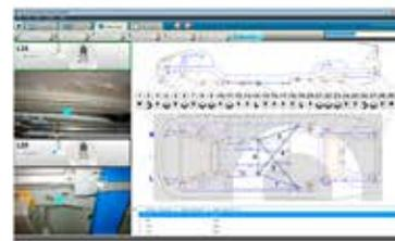
3-Mida y repare el vehículo según los puntos de medición que ha seleccionado. Introduzca los valores e imprima o guarde el informe.
