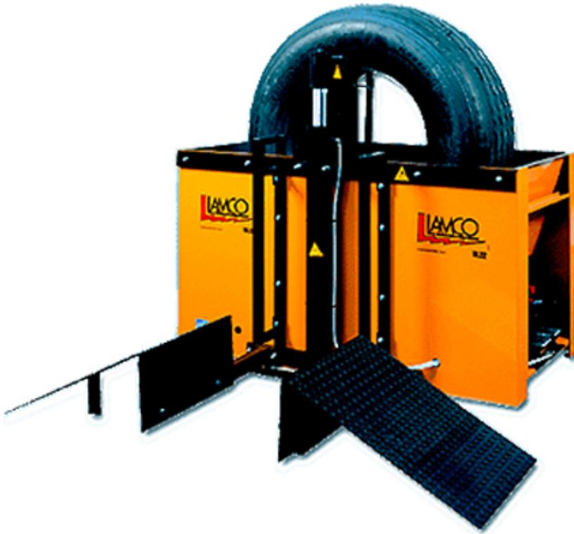
La cuba VL 22 se ha diseñado de una manera muy sencilla y funcional. Su montaje puede hacerse directamente por el minorista, lo que le permite hacer demostraciones poco voluminosas y de bajo costo. Ofrece la posibilidad para tratar neumáticos sin cámara de aire y llantas de hasta 22.5". Está equipada de un filtro de lubricación, dos salidas para el vaciado y limpieza del tanque. El interruptor de pie puede ser montado a la derecha o a la izquierda según los requisitos de instalación.
